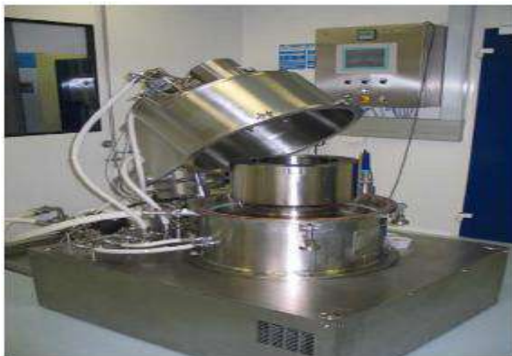
Figure 31. Appareillage muni d'un logiciel d'exploitation programmable pour une purification à grande échelle des globulines par l'acide caprylique, fait par Riera Nadeu (Barcelone, Espagne) (Mpandi et al. 2007).
