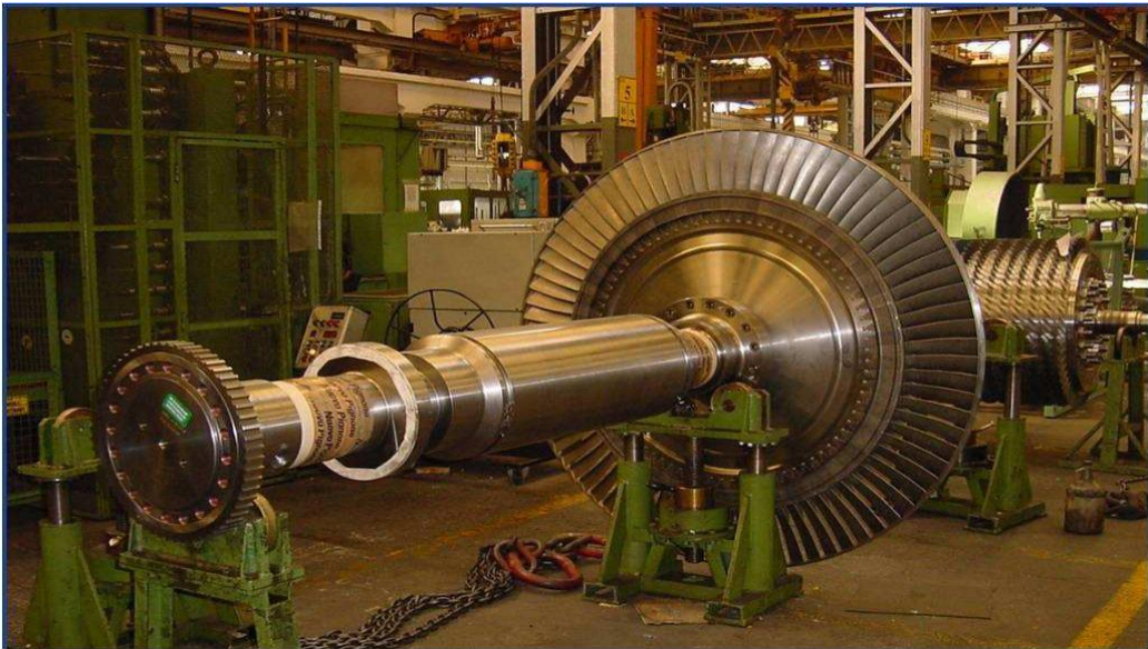
Figure. II.16. Rotor BP de la turbine à gaz MS5002C
