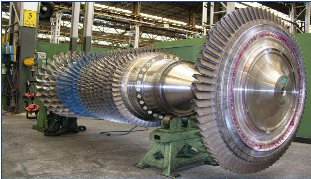
Figure. II.15. Rotor HP de la turbine à gaz MS5002C
