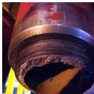
Fig 3-3: Rupture d'une Tige de Forage
