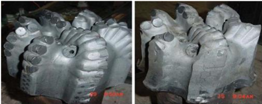
Fig 3-4: Gauche: Outil Neuf, Droite: Outil Ayant Subi des Vibrations Sévères.
