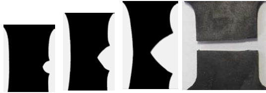
80% 125% 143% Après rupture Fig.7: Mode de propagation de fissure dans le MCB45 après sa démullinisation
