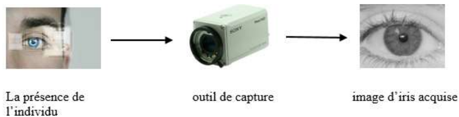
FIGURE 2.1: Étapes d'acquisition d'une image d'iris
