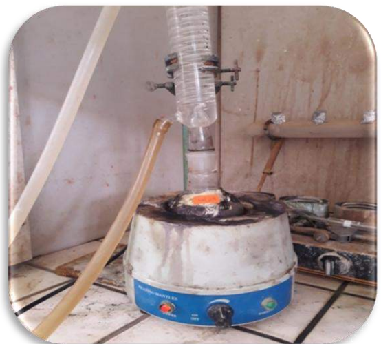
Photo : 6 Chauffe ballon
