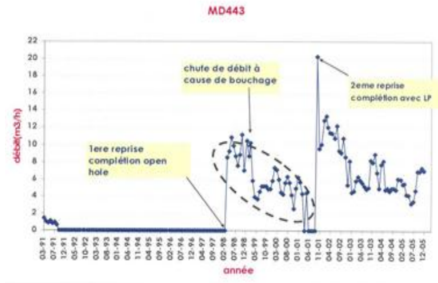
Figure III.6 : Evolution du debit du puit MD443.
