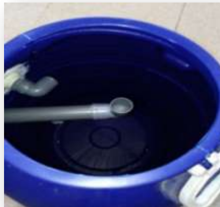
Figure n°13: Vue intérieure du filtre cyclonique
