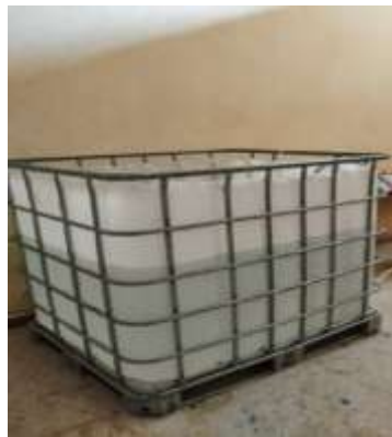
Figure n°03 : Une cuve IBC 1000 litres pour les géniteurs
