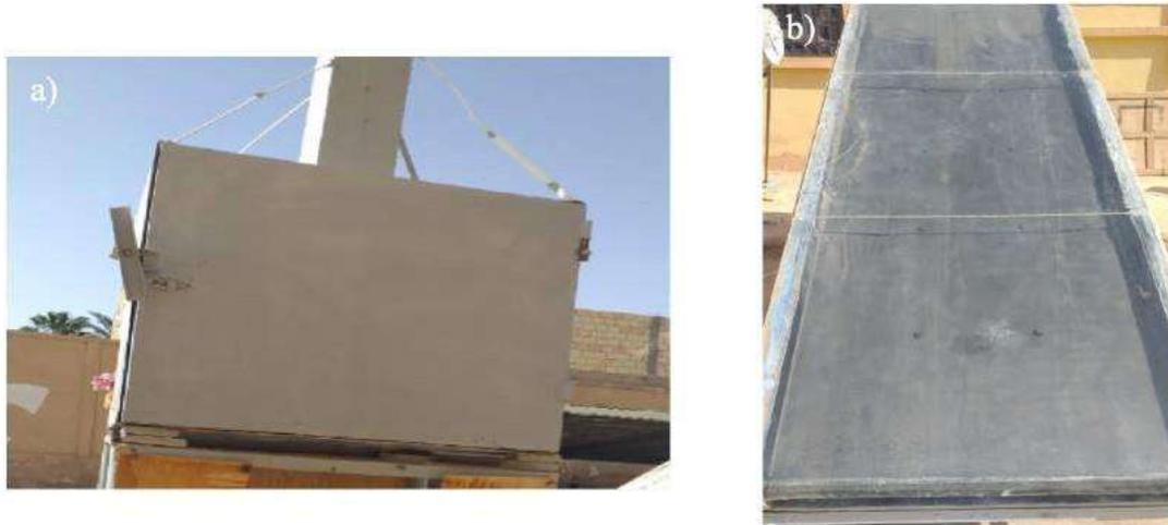
**Figure II.3:** a) La chambre de séchage et b) le capteur solaire.
