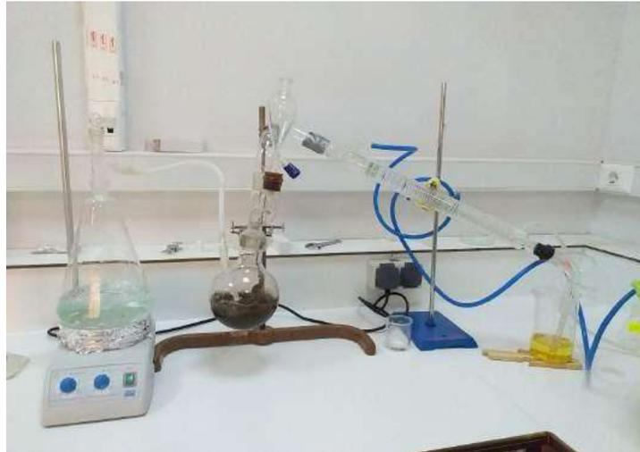
**Appareil de distillation**
