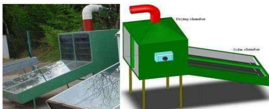
Figure I.6: Schéma explicite du séchoir solaire hybride (S.Khaldi,2018).
