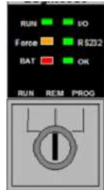
Figure 2. 5. Commutateur à clé (mode de fonctionnement)
