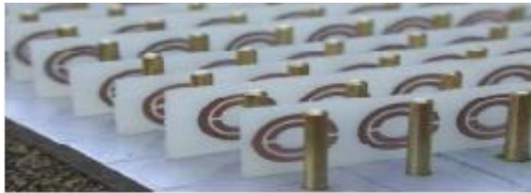
Figure I.5. Première Structure métamatériaux réalisée par le groupe de San Diego [14]
