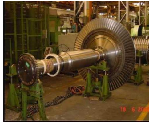
Figure II.4 : Turbine HP avec compresseur et turbine LP avec l'arbre de puissance
