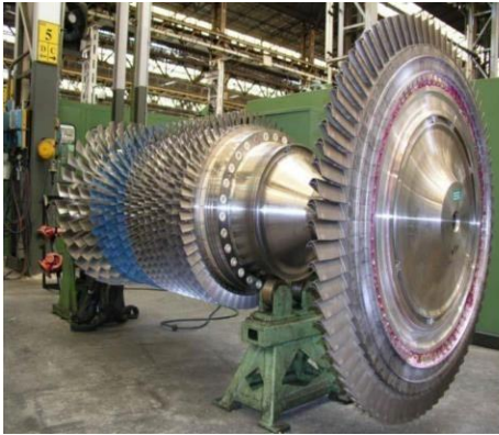
Figure II.4 : Turbine HP avec compresseur et turbine LP avec l'arbre de puissance
