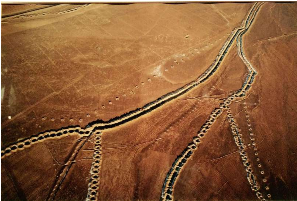
Figure 17 Vue aérienne d'une série de puits de plusieurs qanât en Iran [32].
