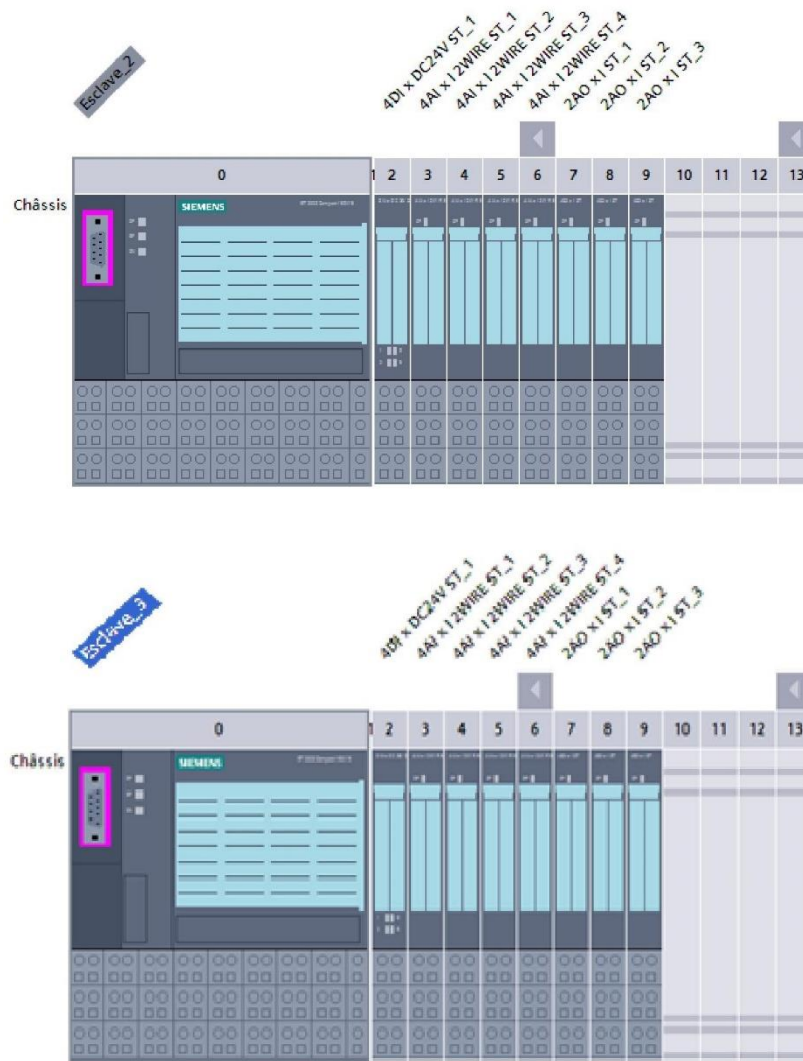
Figure IV. 8: vue des appareils esclave 2 et esclave 3
