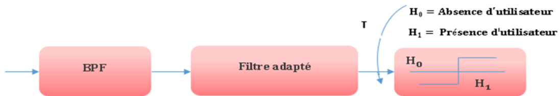
Figure II.6. Schéma fonctionnel du filtre adapté [13].
