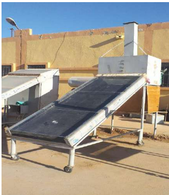
Séchoir solaire indirect
