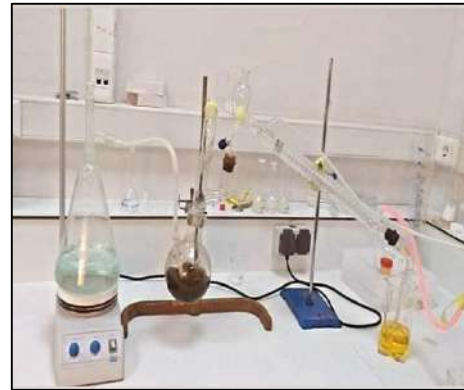
Montage de distillation
