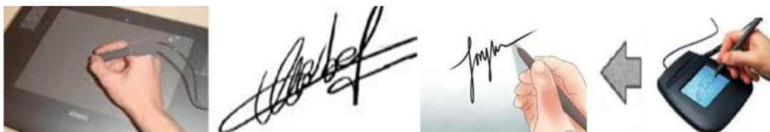
Figure 1. 8: Système biométrique basé sur la signature manuscrite.
