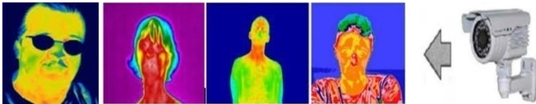
Figure I.13 : Système biométrique basé sur le thermo-gramme facial.
