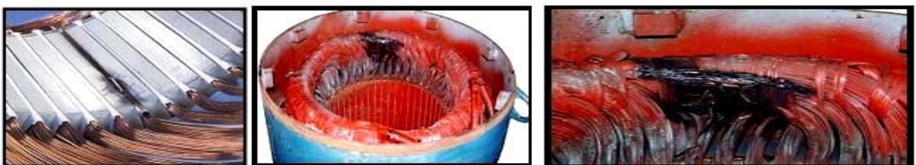
Figure I.6 Exemple de dégâts provoqués par les défauts de court-circuit statoriques
