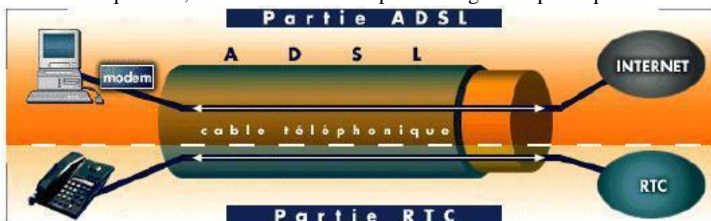
Figure II.3: ADSL & RTC sur la même ligne
