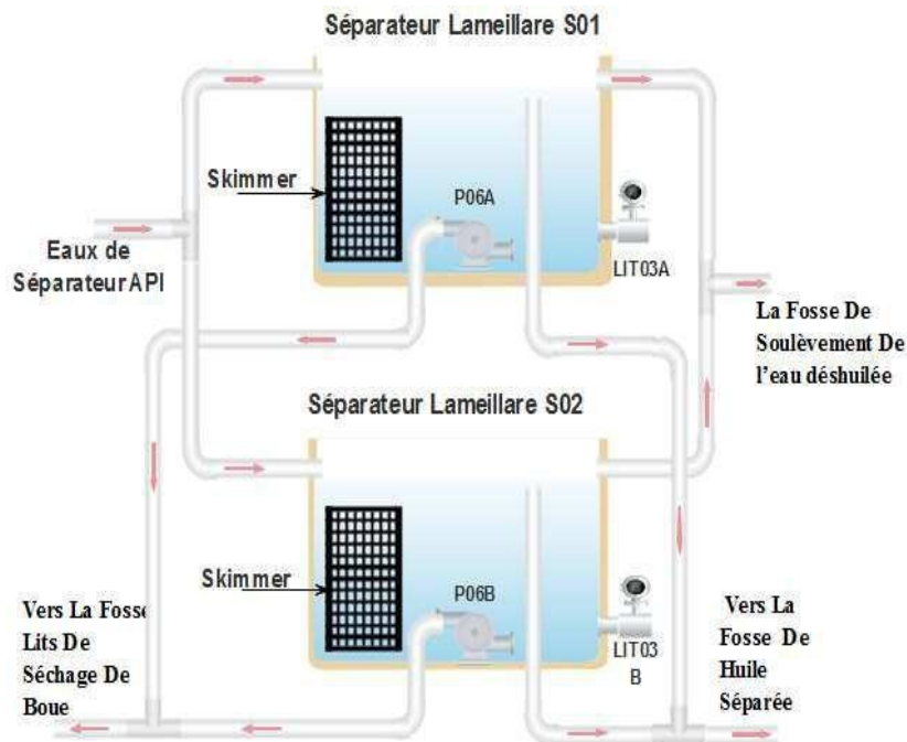
Figure II.4 : Séparateur lamellaire
