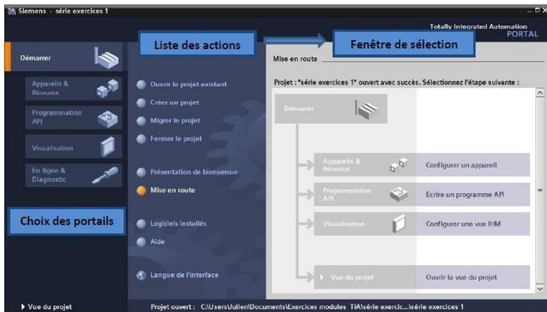
Figure III.6 : Vue du portail [13] .
