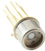
Figure 1.12 : Capteur infrarouge pyro-électrique
