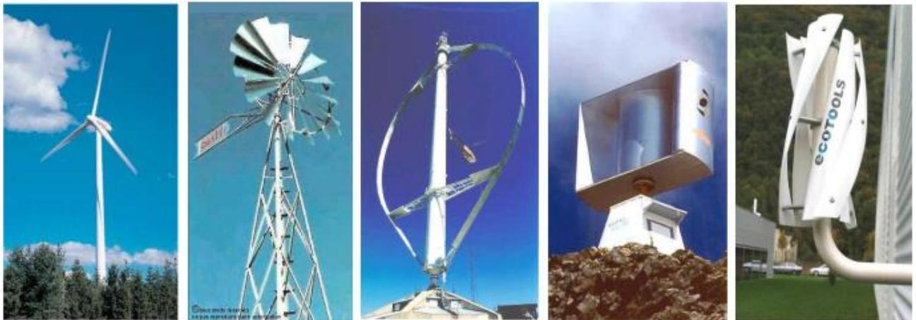
**A.** Eoliennes à axe horizontal**B.** Eoliennes à axe vertical**Figure (1.5) :**TECHNOLOGIES D'EOLIENNES [7]
