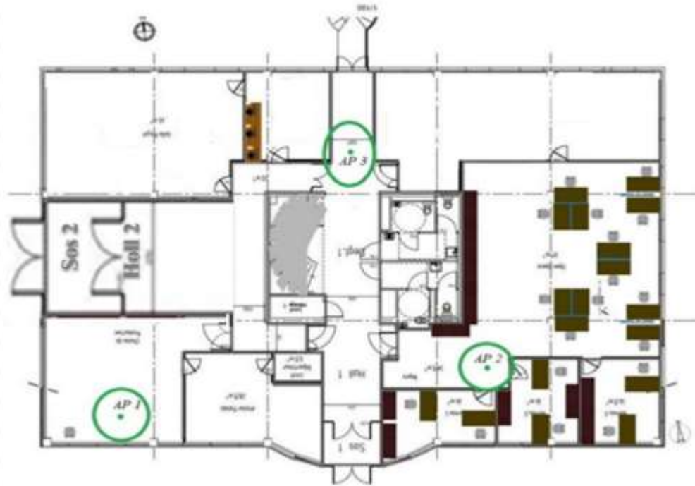
Fig 26. Plan de l'étage de l'immeuble mise à notre disponibilité lors de l'application de notre approche proposée avec les points d'accès (AP).
