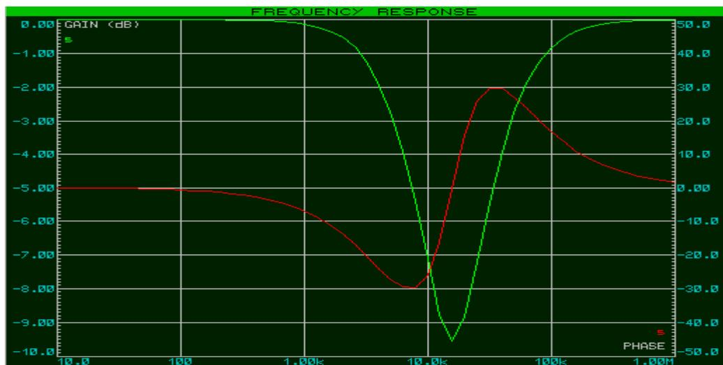
Figure I.21: Diagramme de Bode Filtre coupe-bande [20].
