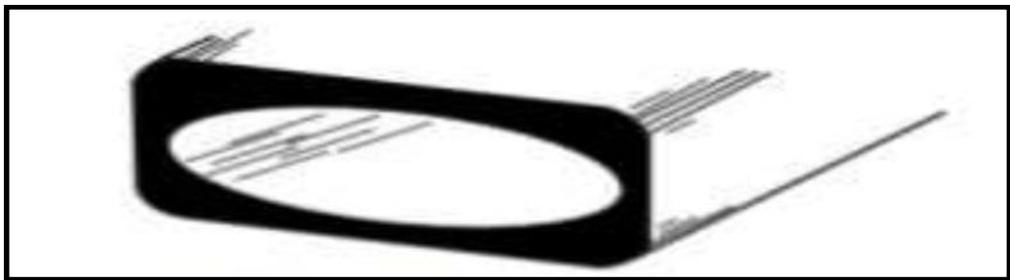
**Figure II.5 :** Guides d'ondes elliptiques.
