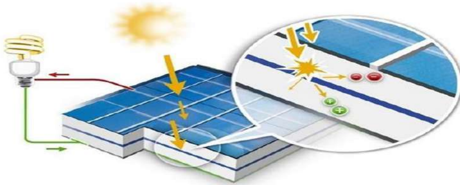
Figure I.8: Principe de fonctionnement d'une cellule solaire PV
