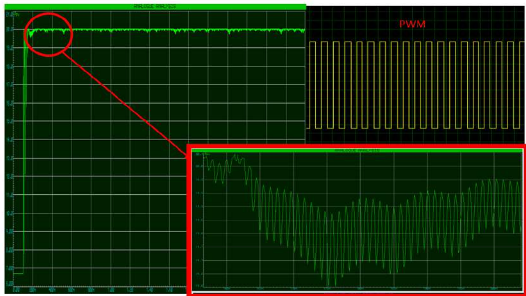
Figure III.7 : Puissance PV à commande MPPT Inc
