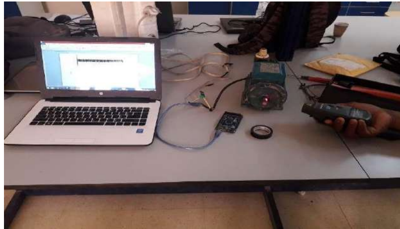
Figure III.6 Banc d'essai moteur asynchrone monophasé.
