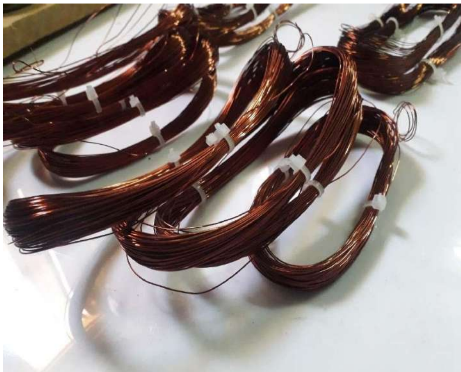
Figure III.3 Les enroulements principaux et auxiliaires
