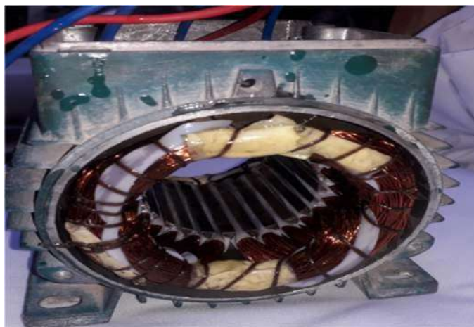
Figure III.5 Enroulements stator d'un moteur asynchrone monophasé
