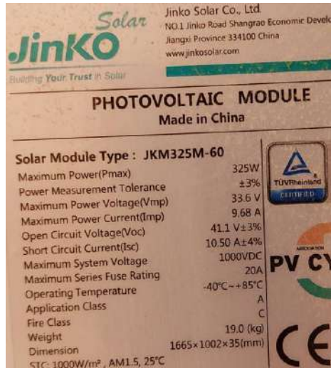
Figure III.9: caractéristique du panneau photovoltaïque jinkosolar JKM325M-60
