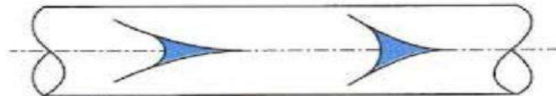
Figure 18. Criques de surface appelées pattes de corbeaux [25].
