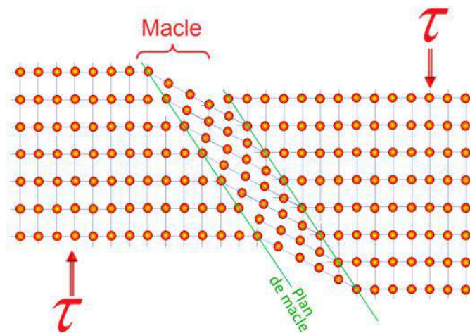
Figure 10. Déformation par maclage.
