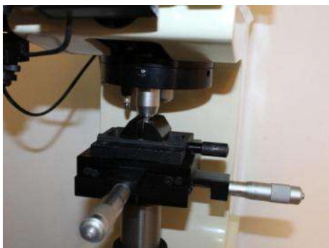
Figure 38. Porte échantillon et pénétrateur.
