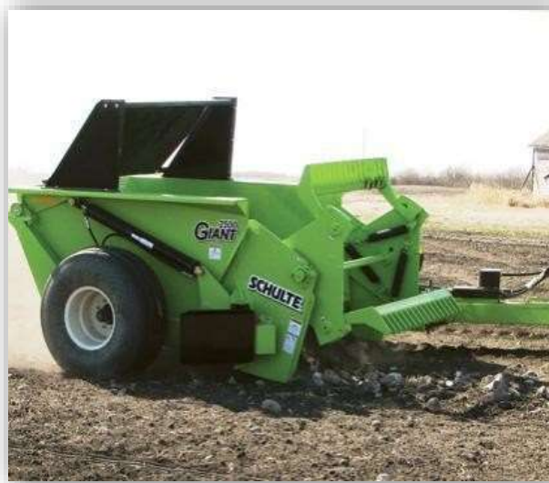
Figure (II-3) : Ramasseuse de pierres Schulte Giant 2500
