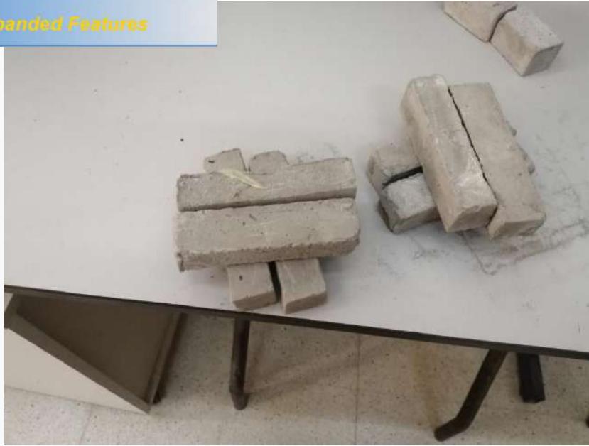
Figure 20: les échantillons après 4 et 28 jours
