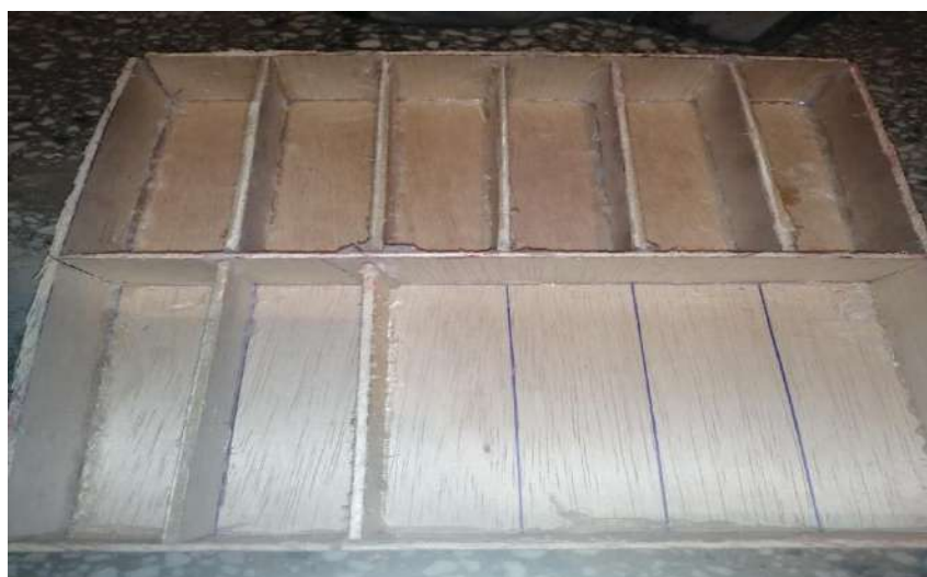
Figure17: les moules préparé
