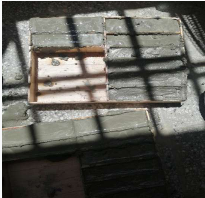
Figure19: les mélanges dans les moules
