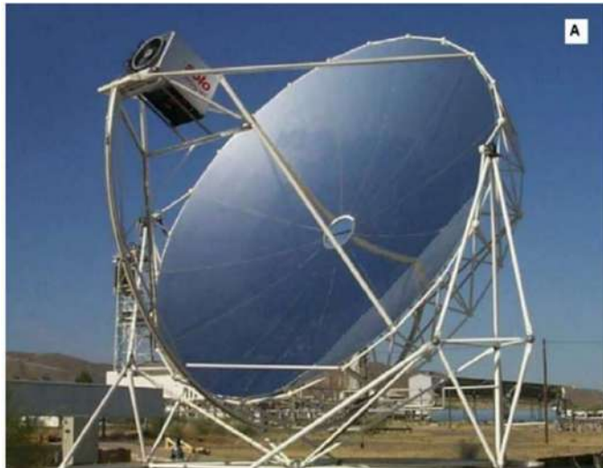
Fig 3.2 : Capteur parabolique et sphérique. [3]
