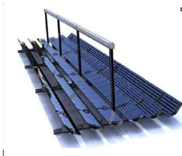
Fig 3.5 : Captures solaires type Fresnel. [3]
