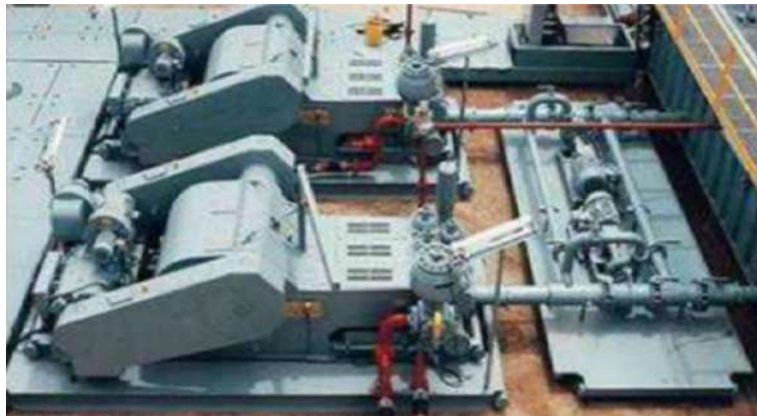
Figure I. 2: pompe à boue triplex simple effet. [1]
