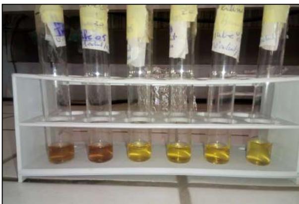
Différentes concentrations de sirop de dattes avec le DPPH après 24h dans l'obscurité.
