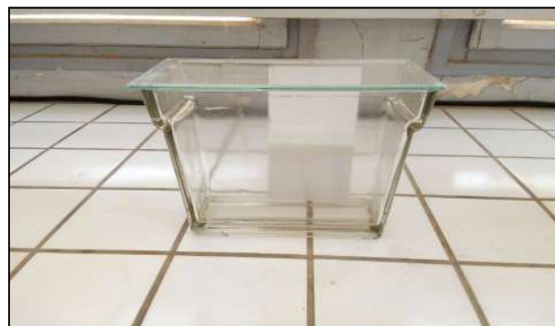
Plaque CCM immergée dans la cuve saturée, la phase mobile ( Acide acétique - eau - butanol )
