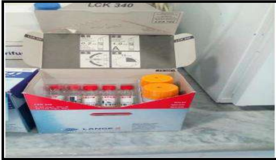
الشكل (IV - 21): صورة توضح الكاشف المستعمل لقياس النترات المسمى LCK 340
