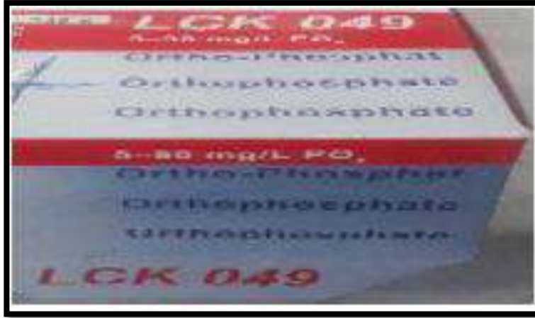
الشكل (IV - 20): الكاشف المستعمل لقياس اورثو فوسفور PO_4 (LCK 049)
