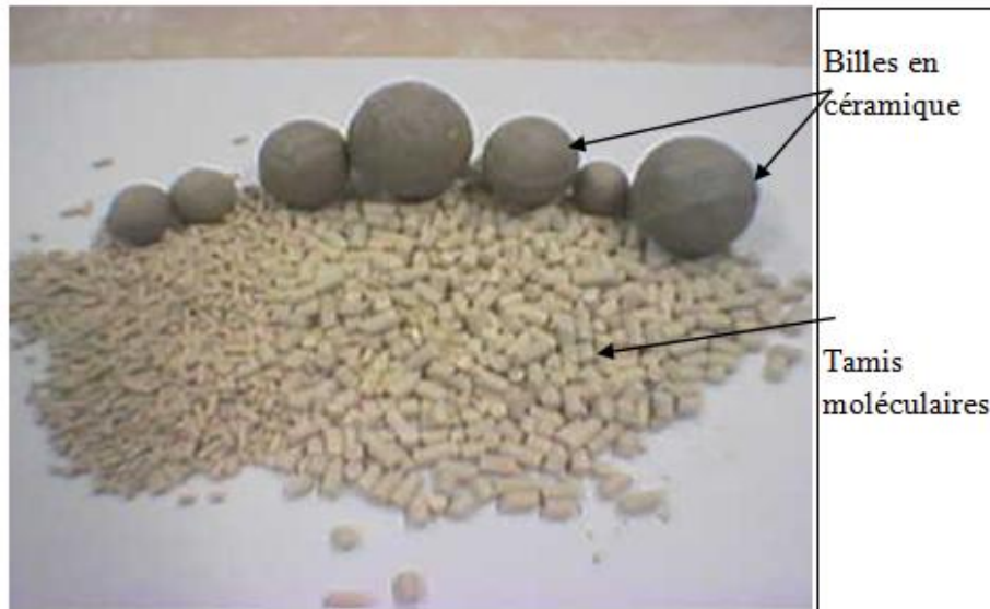
Figure (12) tamis moléculaires + billes de céramique
