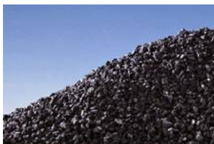
Figure 3: Charbon actif granulé
