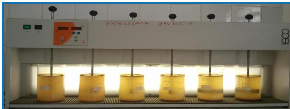
**Figure II.3**: Floculateur ISCO.
