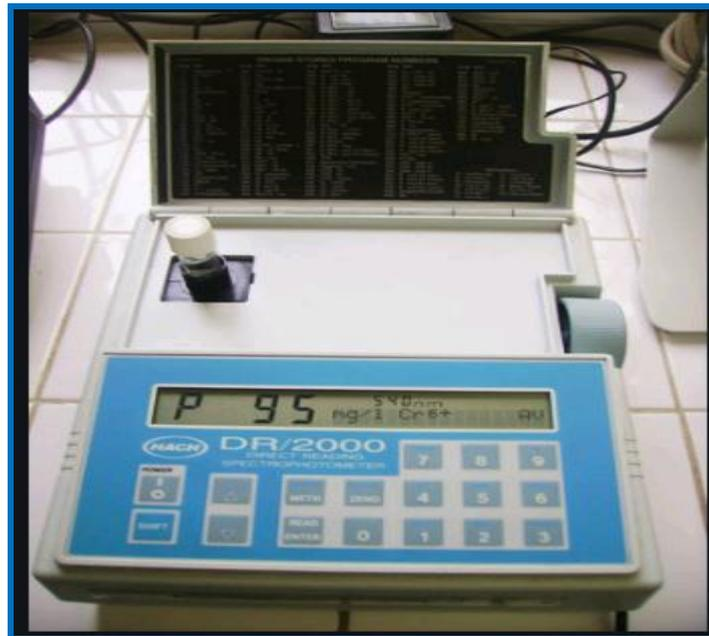
**Figure II.2** : Spectrophotomètre DR/2000.
