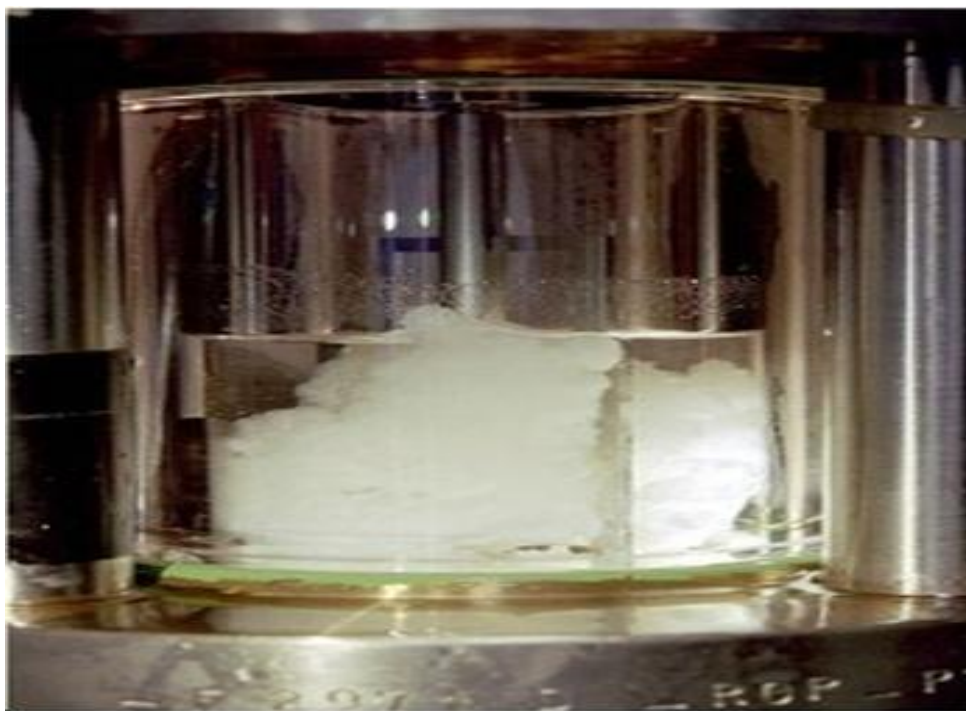
Figure III.2 : Photo de cristaux d'hydrates dans un réacteur agité.
