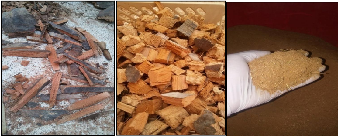
Fig. (III.8) : Procédé du broyage du bois de palmier dattier.
