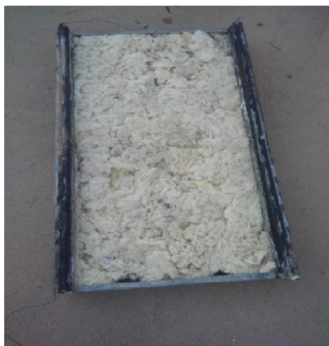
Fig. (III.14) : le capteur réalise avec laine de mouton
