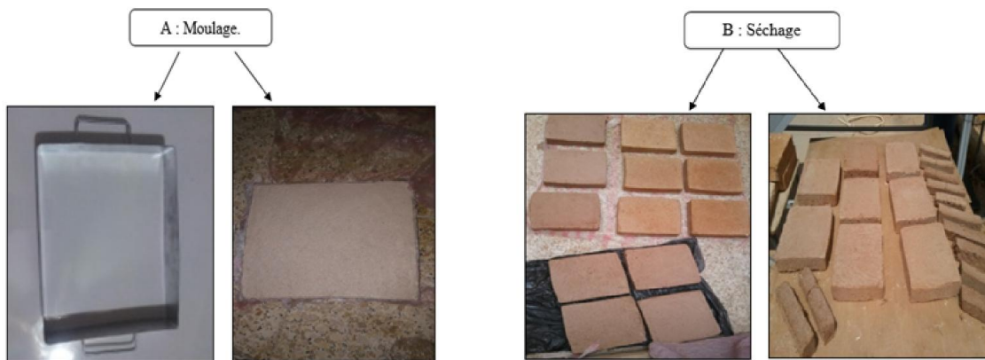
Fig. (III.10) : Préparation de couche isolant.
