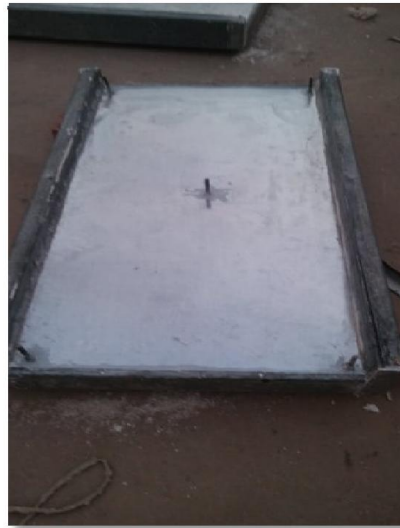
Fig (III. 15) un prototype réalisé par polystyrène
