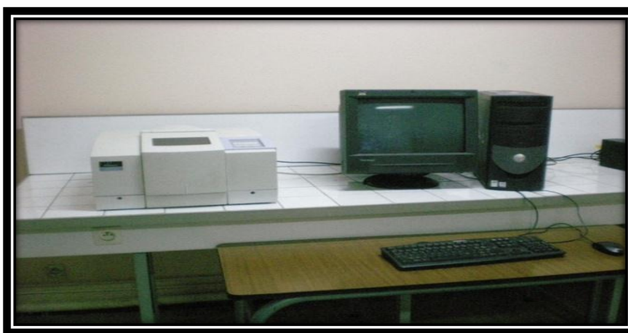
Figure II.2 : Appareil de l'infrarouge (IR-FT, AVATAR320 FT-IR, THERMO-NICOLET)
