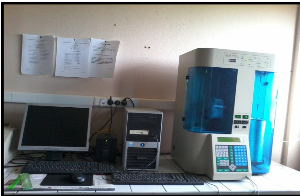
Figure II.3: L'appareil NOVA 1000 utilisé pour les mesures BET.
