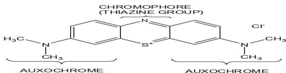
Figure I-3-Structure du bleu de méthylène
