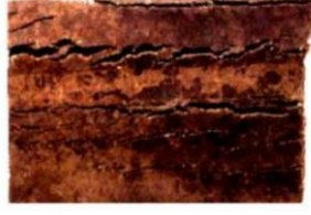
الشكل (1-9) : صورة للتآكل الإجهادي [5]
