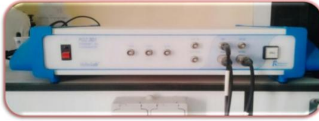
الشكل (V-10) : صورة لجهاز potentiostat من نوع PGZ301
