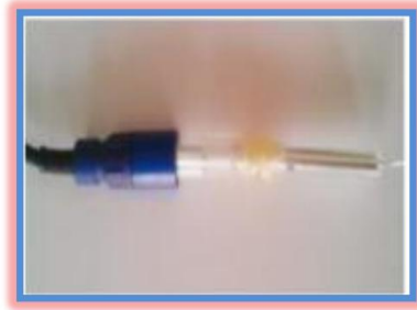
الشكل (V-12) : صورة للالكترود المساعد (CE)
