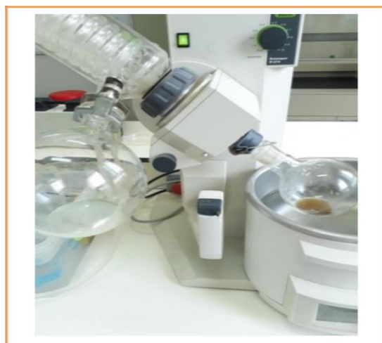
الشكل (IV-4) : صورة لجهاز التبخير الدوراني
