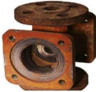
الشكل (1-2) :صورة للتآكل المنتظم [5]
