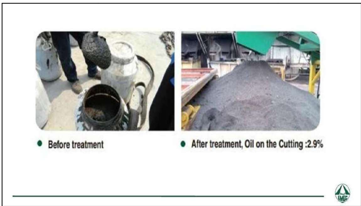
Figure.III.7.Cutting avant et après le traitement [30].
