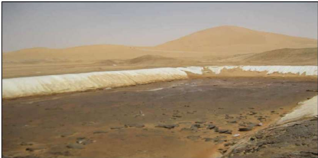
Figure.III.9.Bourbiers après une opération de forage[32].
