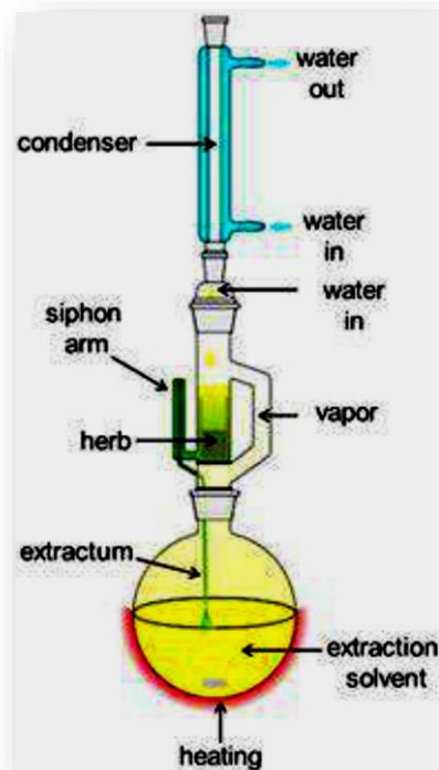
Figure III.4 : Schéma de l'appareil d'extraction Soxhlet [11].
