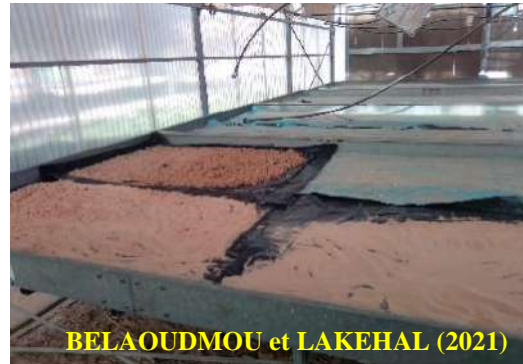
Photo6 : Séchage du sable sous serre
