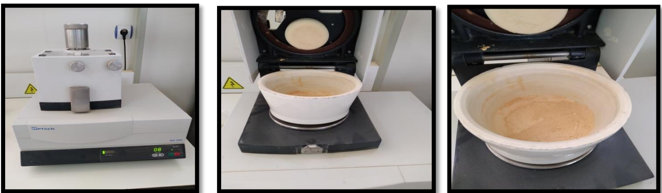
Image 5 : processus de broyage d'argile.
