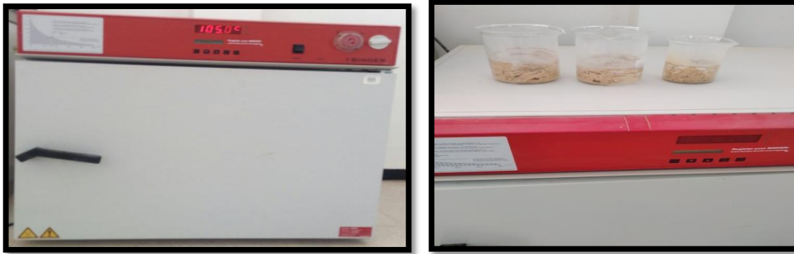
Image4 : processus de séchage de l'argile.
