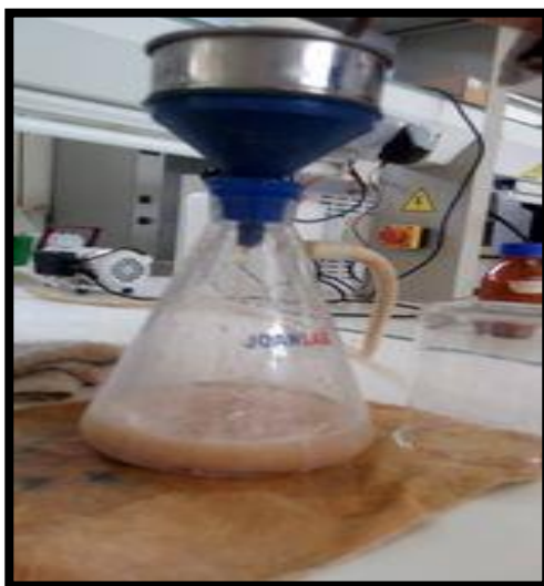
Image2 : processus de tamisage à travers un tamis 40 \mu\text{m} .
