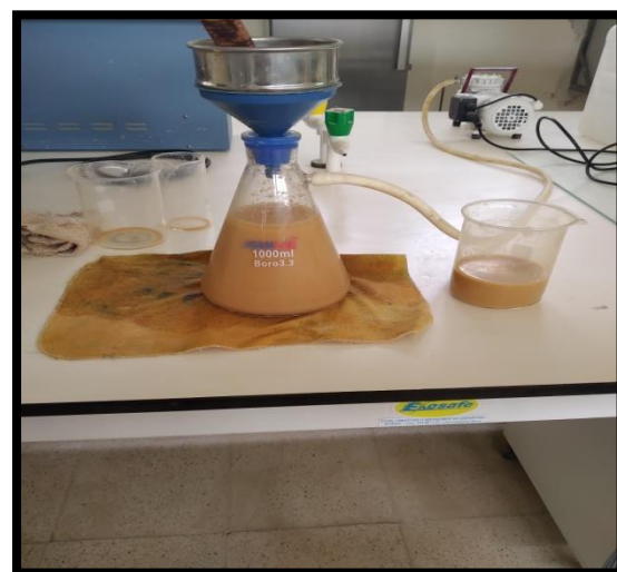
Image2 : processus de tamisage à travers un tamis 40 \mu\text{m} .
