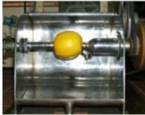
Fig.08 : Montage d'extraction par la méthode d'expression à froid [19].
