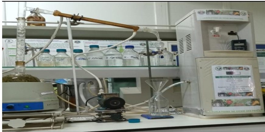
Fig.02: Montage d'extraction par Hydrodistillation
