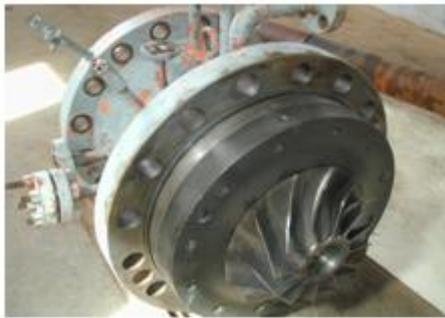
Figure (II.4) : roue du compresseur
