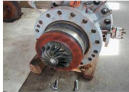
Figure (II.5) : Roue de la turbine
