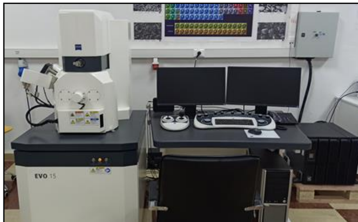
Figure 20: Image de Microscopie électronique à balayage utilisé dans cette étude
